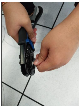
ภาพที่ 2.42 แสดงภาพเอาสายกับหัวสอดเข้าไปในคีม
