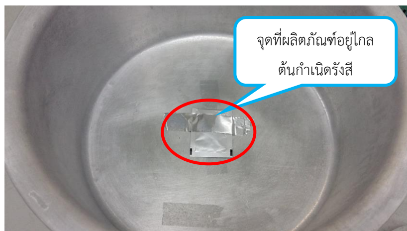
ภาพที่ 3.115 การติดแผ่นวัดปริมาณรังสีจุดที่กะโหลกศีรษะเทียมอยู่ใกล้ต้นกำเนิดรังสี
