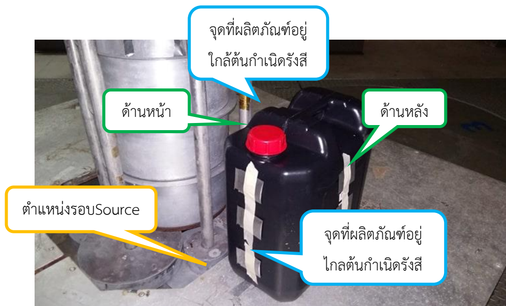
ภาพที่ 3.128 การฉายรังสีแกมมาน้ำยารักษาโรค
