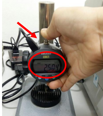
ภาพที่ 3.81 บันทึกราคาแผ่น gauge block ความหนา 2.5 mm ที่เชื่อมต่อกับโปรแกรม
