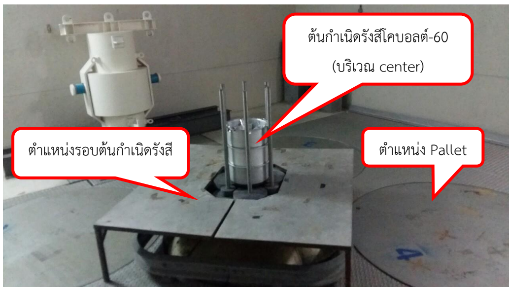
ภาพที่ 4.1 บริเวณเครื่องฉายรังสีแกมมาโคบอลต์-60
