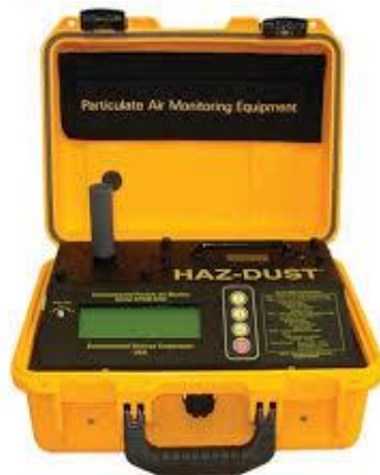
ภาพที่ 2.1 เครื่องมือที่อาศัยหลักการกระจายของแสง ที่มา Bondu engineering 2018
