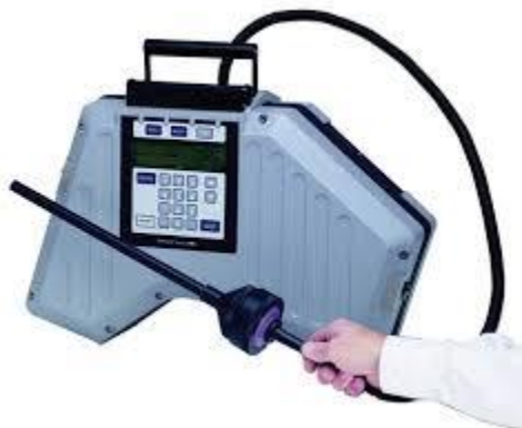
ภาพที่ 2.2 เครื่องมือที่อาศัยหลักการแตกตัวเป็นไอออน ที่มา Bondu engineering 2018
