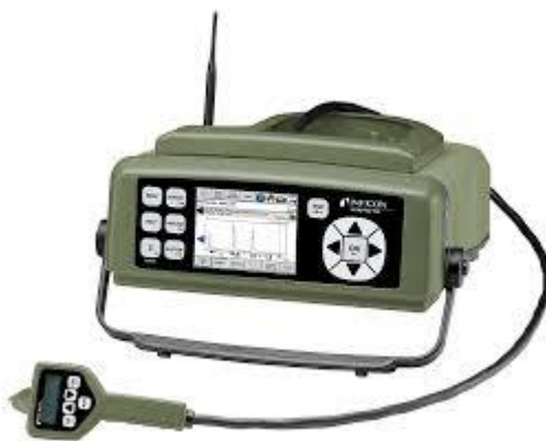
ภาพที่ 2.4 เครื่องมือที่อาศัยหลักการแยกชั้นของก๊าซโดยการซึมผ่านวัสดุดูดซับ ที่มา Bondu engineering 2018
