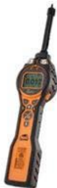
ภาพที่ 2.3 เครื่องมือที่อาศัยหลักการวัดความเข้มชั้นของแสง ที่มา Bondu engineering 2018
