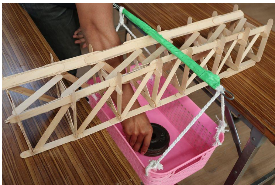
ภาพ 10 ทดสอบการรับน้ำหนักของสะพาน ที่มา : อุทยานการเรียนรู้ศรีรัตน มทส.
