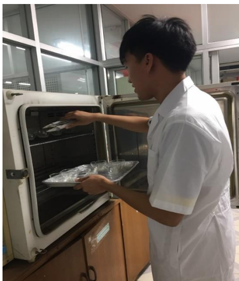
ภาพที่ 2.8 อบและชั่งน้ำหนักภาชนะการกรองของแข็งที่แขวนลอยอยู่ในน้ำ
