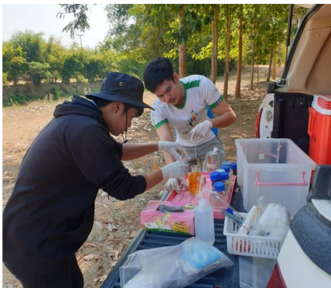
ภาพที่ 2.13 วัดค่าภาคสนาม pH, ความขุ่น, การนำไฟฟ้าจังหวัดสระแก้ว
