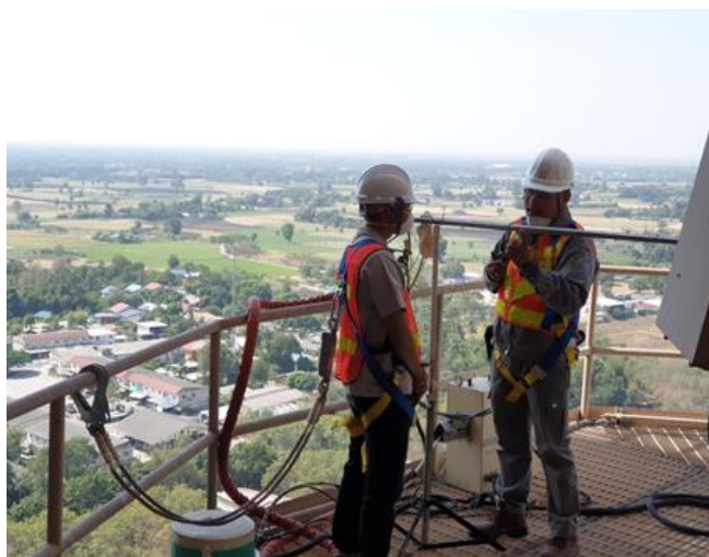
ภาพที่ 2.15 ขึ้นสำรวจปากปล่องควัน โรงงานอุตสาหกรรม อ.พระพุทธบาท จ.สระบุรี
