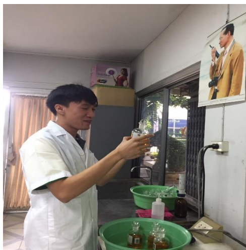
ภาพที่ 2.5 ละลายตะกอนก่อนนำไปไทเทรต
