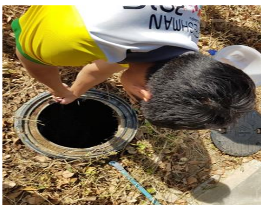
ภาพที่ 2.3 เก็บตัวอย่างน้ำระบบบำบัดน้ำเสียภายในเรือนจำสระบุรี
