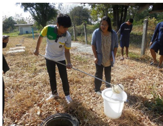
ภาพที่ 2.3 เก็บตัวอย่างน้ำระบบบำบัดน้ำเสียภายในเรือนจำสระบุรี
