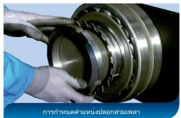
รูปที่ 2.12 การติดตั้งตลับลูกปืนโดยใช้ปลอกปรับขนาดเพลลา
