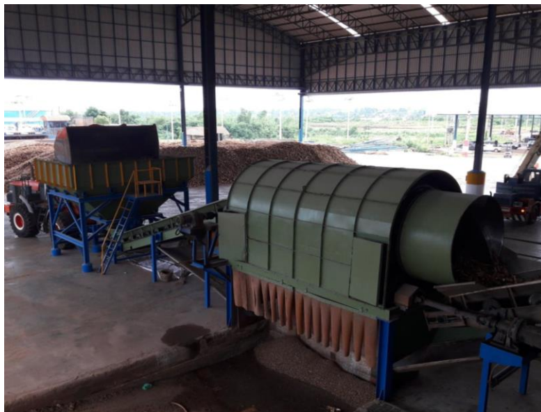
รูปที่4.1 รูปเครื่องร่อนเปลือกดินมันสำปะหลัง
