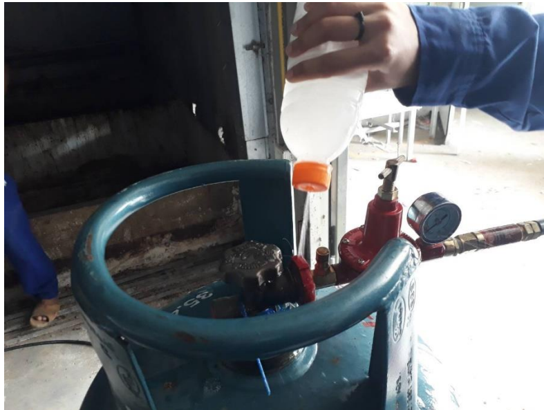
ภาพที่ 3-2 ภาพการทดสอบแก๊สรั่วด้วยน้ำฟองสบู่
