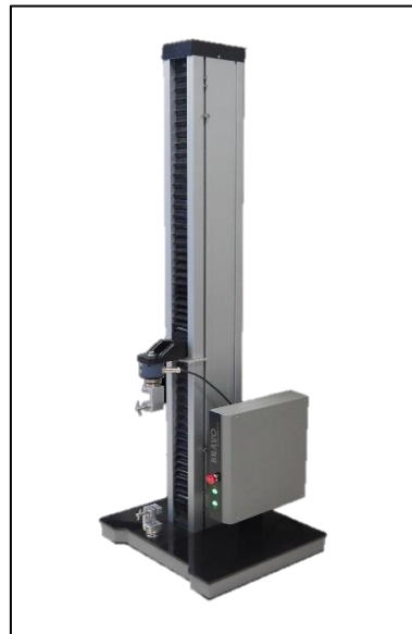
ภาพที่ 3.8 เครื่องมือการทดสอบ (Universal Testing Machine NTM)
