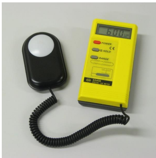
ภาพที่ 3 แสดง Digital Lux Meter ยี่ห้อ BEHA รุ่น 93408
