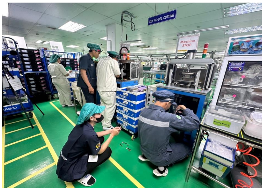
ภาพที่ 2 หาแหล่งกำเนิดเสียงของเครื่องจักรด้านล่างเครื่องจักร Key cut
