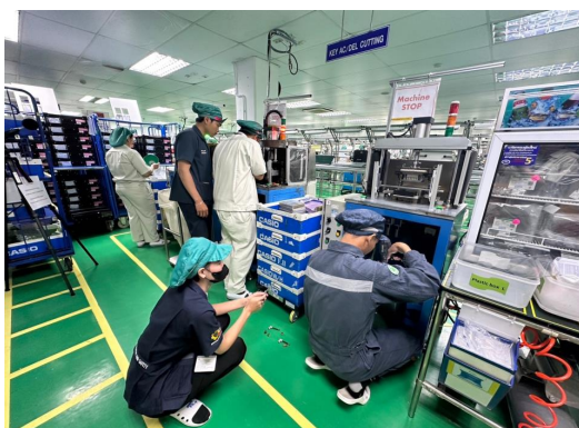
ภาพที่ 2.2 หาแหล่งกำเนิดเสียงด้านล่างเครื่องจักร
