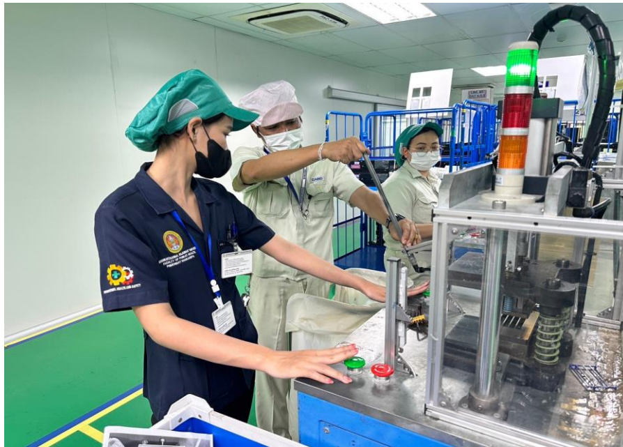
ภาพที่ 1 หาแหล่งกำเนิดเสียงของเครื่องจักรด้านบนเครื่องจักร Key cut
