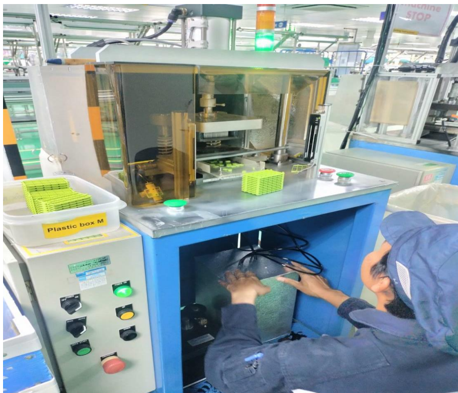
ภาพที่ 6 ติดตั้งกล่องดูดซับเสียงด้านล่างเครื่องจักร Key cut
