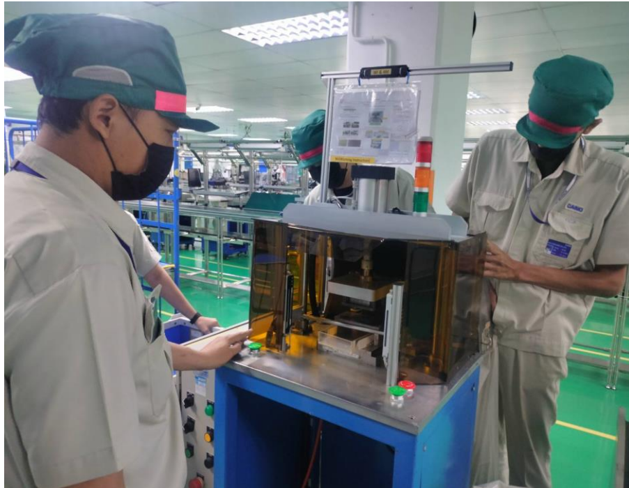
ภาพที่ 5 ติดตั้งการ์ดและวัสดุดูดซับเสียงด้านบนเครื่องจักร Key cut
